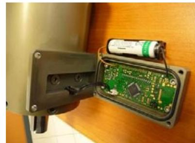
Utiliza una pila AA Li- SOCL2 3,6V
