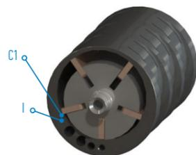
Los dos lados de la cámara tienen dimensiones diferentes, por lo que la fuerza aplicada a cada lado es diferente, generando un movimiento de rotación en el rotor.
