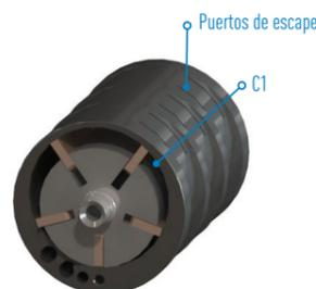
Al cambiar el punto de inyección, el rotor gira en la dirección opuesta. Por lo tanto, es posible cambiar de la rotación en el sentido de las agujas del reloj a la rotación en sentido contrario a las agujas del reloj simplemente cambiando el punto de inyección en el motor.
