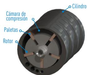
Se inyecta aire a presión (de 4 a 6 bares) en el motor neumático a través del punto de inyección (I). Entra en la primera cámara de compresión (C1), que por lo tanto está presurizada. Esta presión aplica una fuerza en todos los lados de la cámara. Esta fuerza es proporcional a la superficie a la que se aplica.
