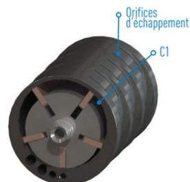
En changeant le point d'injection, le rotor tourne dans l'autre sens. Ainsi, il est possible de passer d'une rotation dans le sens des aiguilles d'une montre à une rotation dans le sens inverse en changeant simplement le point d'injection sur le moteur. Le sens de rotation de l'arbre de sortie du moteur est défini en le regardant de l'arrière (côté entrée d'air).
