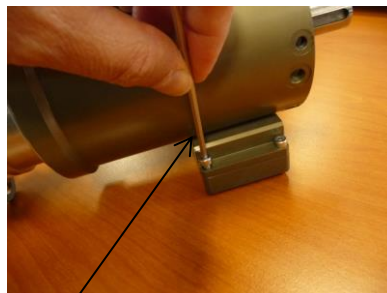
Utilice una pila AA 3,6V Li-SOCL2
